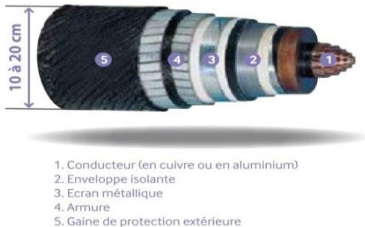
**Figure 1 : Représentation schématique de la constitution d'un câble sous-marin (RTE)**
